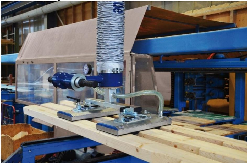
Schlauchheber mit 75 kg Traglast. Bild: Aero-Lift
