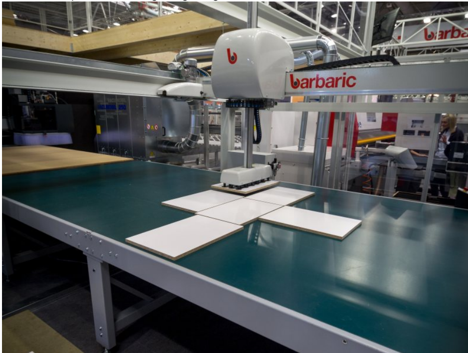
Die neue, vollautomatische Abstapelanlage. Bild: Barbaric
