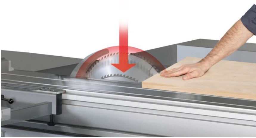
Das Preventive Contact System verhindert Unfälle. Bild: Felder
