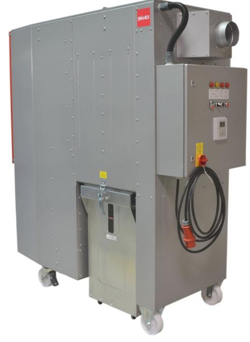
Neuer Mitteldruckentstauber. Bild: Spänex
