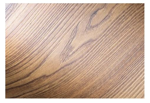
Die neue 3D-Struktur verläuft exakt synchron mit dem Druckbild. Bild: Continental/Hornschuch
