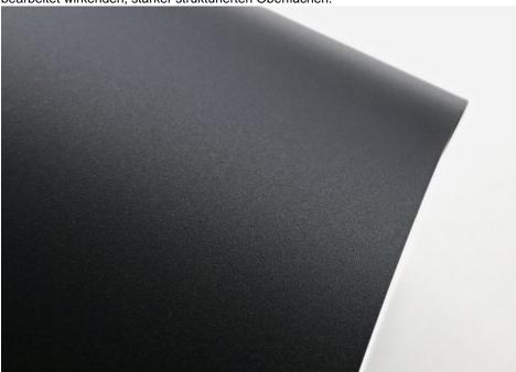
Die matte Oberfläche kombiniert Robustheit, Anschmutzverhalten und Kratzbeständigkeit mit einer angenehmen, feinen Haptik. Bild: Continental/Hornschuch
