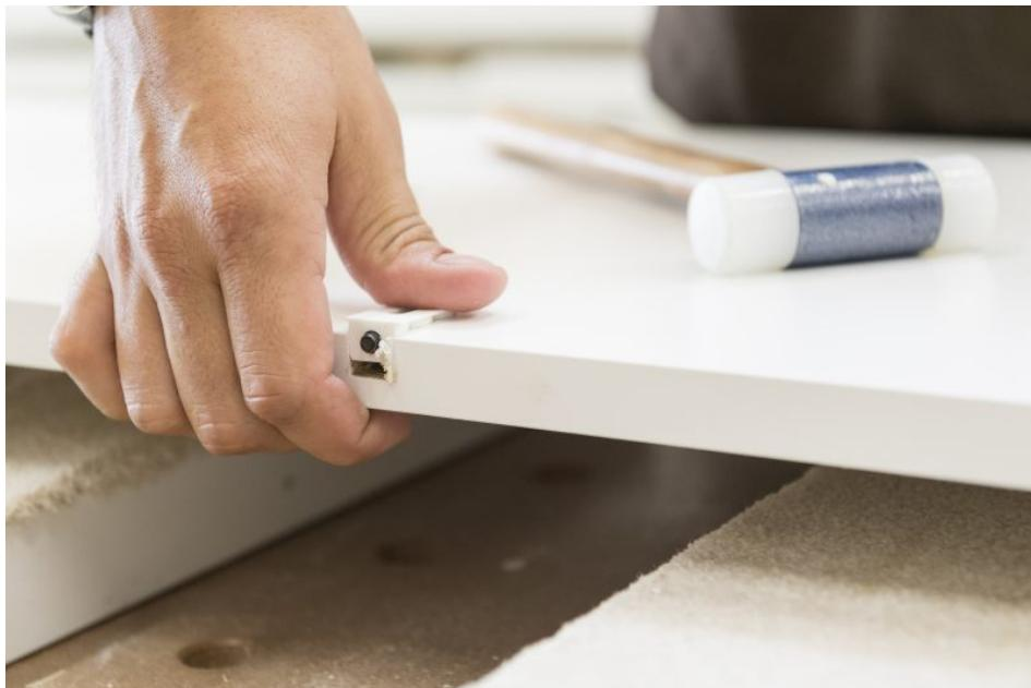
Die »Cabineo«-Verbinder werden in der Schreinerei ins Werkstück montiert und als Flatpack auf die Baustelle transportiert. Bild: Lamello
