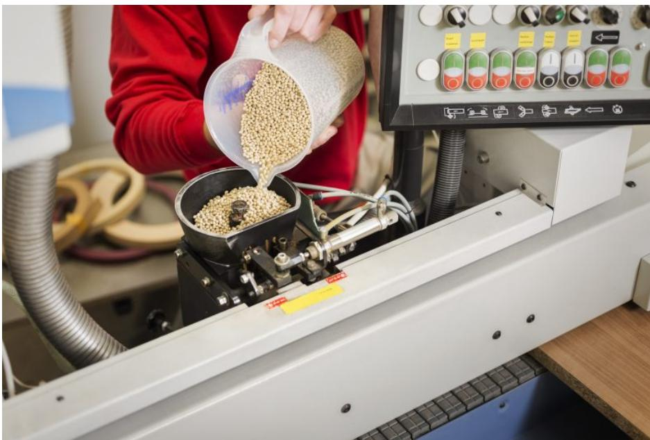
Wer das Klebstoffbecken regelmäßig reinigt, erhält gute Ergebnisse bei der Verklebung der Kanten. Bild: Ostermann
