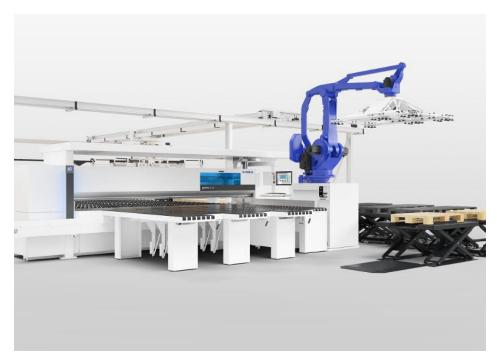
Mit den neuen Robotersägen profitieren kleine und mittlere Betriebe von Losgröße-1-Fertigung mit bis zu 800 Teilen pro Schicht, geringen Stückkosten und mannloser Fertigung. Bilder: Homag
