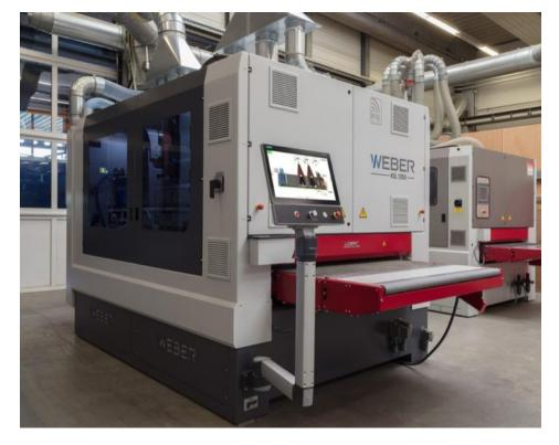
Bei den Doppelkopfschleifmaschinen sorgen Servomotoren von Siemens für maximale Vorschubgeschwindigkeiten. Bild: Siemens
