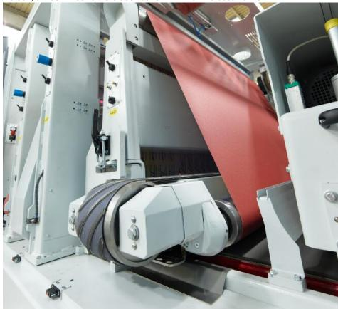
Das CBF-Aggregat von Weber erzeugt ein besonders hochwertiges Finish. Innerhalb der Breitbandstation ist ein quer laufendes Drucklamellenband angeordnet. Bild: Siemens
