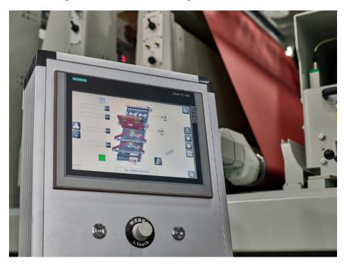
Schleifautomaten von Weber sind mit »Simatic Comfort Panels« ausgerüstet. Der »i-Touch« ermöglicht den Direktzugriff auf wichtige Funktionen. Bild: Siemens
