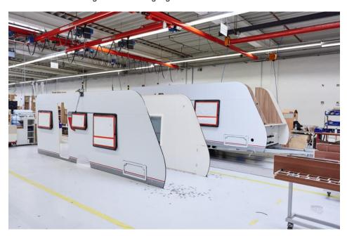
in Camper-Traum wird wahr: Montage des Caravan-Aufbaus mit den auf Maka-Maschinen produzierten Teilen in Sandwich-Bauweise. Bild: Maka/Makis Foteinopoulos
