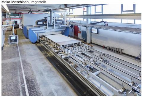
Höchste Ausbeute: Die Pressung wird optimal in Werkstücke aufgeteilt. Bild: Maka/Makis Foteinopoulos
