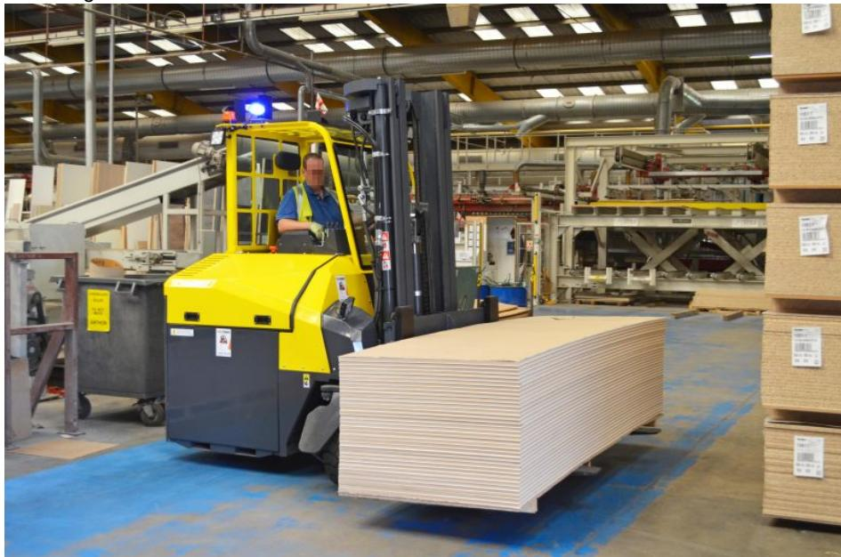
Der »Combi-CB4E« mit Elektroantrieb bietet vier Tonnen Tragkraft und manövriert sicher um die Fertigungsmaschinen im Produktionsbereich. Bild: Combilift
