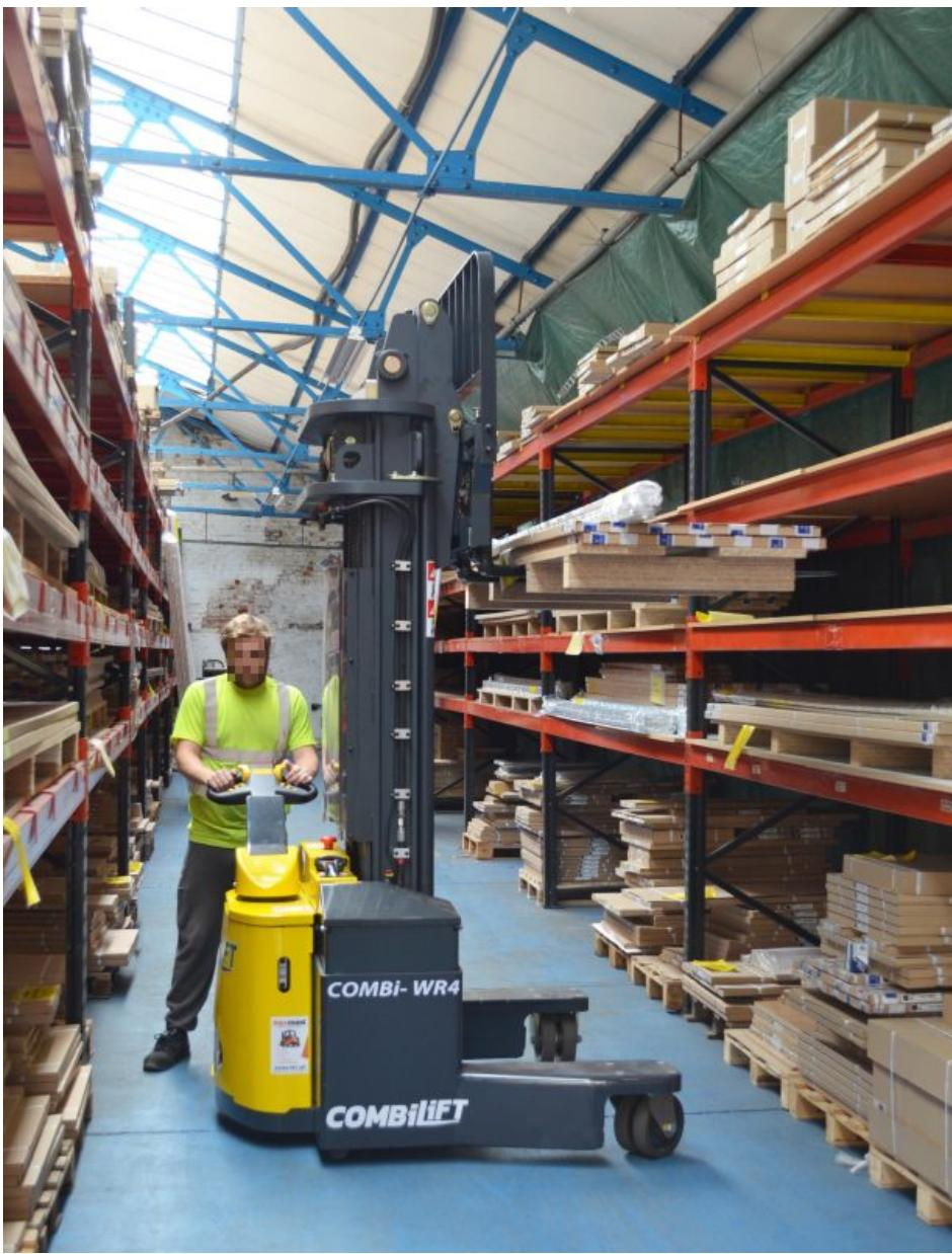
Beim Deichselstapler »Combi-WR4« kann der Bediener seitlich zum Gerät stehen und hat volle Sicht auf Ladung, Gabeln und die Arbeitsumgebung. Bild: Combilift
