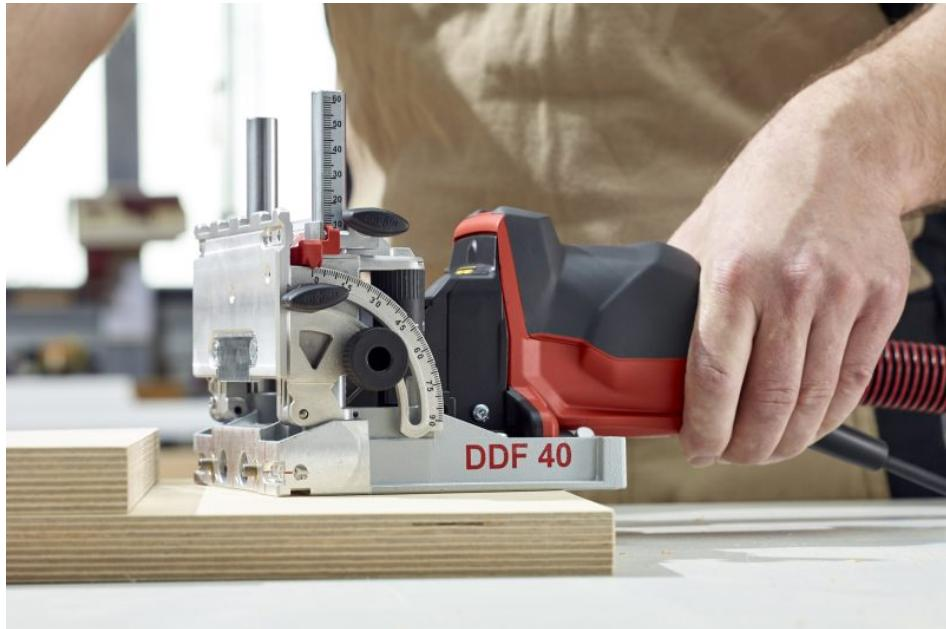
Anlegen, bohren, fertig. Mit dem neuen »Duodübler DDF 40« von Mafell entstehen Löcher für Dübelverbindungen ohne Ausmessen und Anreißen. Bild: Mafell
