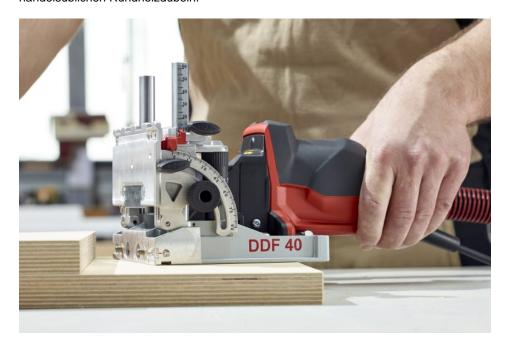
Anlegen, bohren, fertig. Mit dem neuen »Duodübler DDF 40« von Mafell entstehen Löcher für Dübelverbindungen ohne Ausmes-sen und Anreißen. Bild: Mafell
