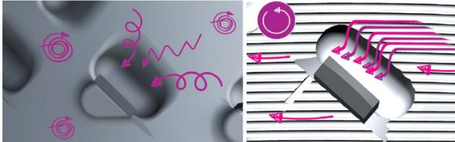
Luftverwirbelungen an der Schneide führen zu Lärmemissionen (links). Die neue Oberflächenstruktur des Grundkörpers bildet bei genauer Betrachtung des Spanraums eine ungleichmäßig geformte »Eulenflügelkante«, welche die Luft an dieser Stelle kanalisiert und damit die Lärmemission minimiert (rechts). Bilder: Leuco
