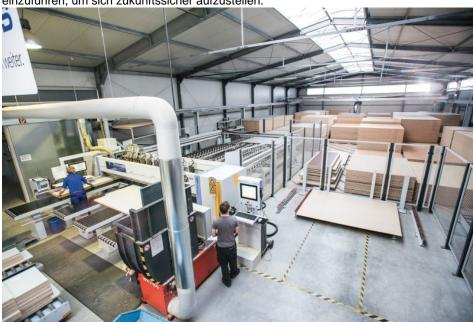
Mit einem automatisierten Blechbearbeitungs-Zentrum sowie einem automatisierten Plattenlager mit Zuschnittoptimierung erzielt Reiss eine überdurchschnittlich hohe Effizienz seiner Wertschöpfungsprozesse. Bild: Vlex
