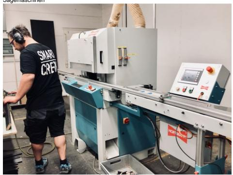
Eine kundenspezifisch modifizierte Doppelgehrungssäge von Hoffmann zur Fertigung von Rahmenfronten (Spectral). Bild: Hoffmann
