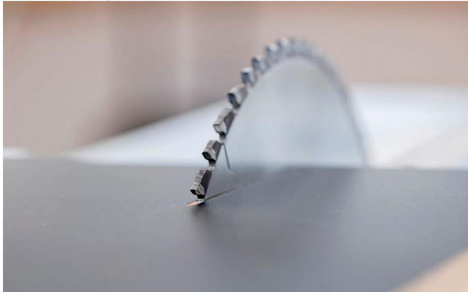
Leitz bietet Werkzeuglösungen für den Möbelbau, z. B. Kreissägeblätter für den Plattenzuschnitt. Bild: Leitz
