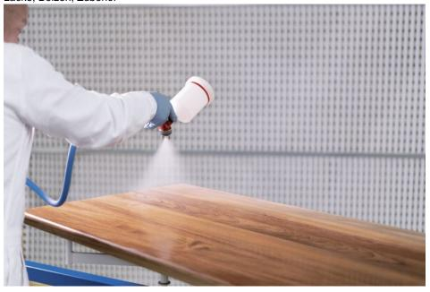
Die neuen 4-in-1-Lacke von Remmers können mittels Airless-Spritztechnik schnell und einfach aufgebracht werden. Bild: Remmers
