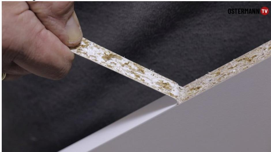
Die Abrissprobe zeigt einen gleichmäßig dünnen Klebstoffauftrag. Bild: Ostermann
