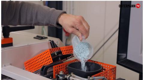
Vor der Rückstellung auf EVA wird Reinigungsgranulat eingefüllt, um das Ausreagieren von PUR-Rückständen in der Maschine zu verhindern. Bild: Ostermann
