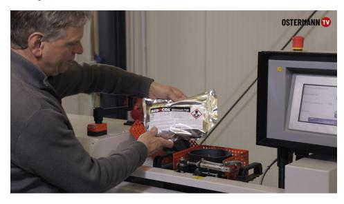
Vor der Verarbeitung von PUR-Klebstoffen muss sichergestellt sein, dass die Kantenanleimmaschine geeignet ist. Bild: Ostermann
