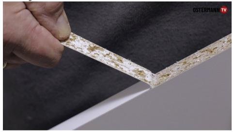
Die Abrissprobe zeigt einen gleichmäßig dünnen Klebstoffauftrag. Bild: Ostermann
