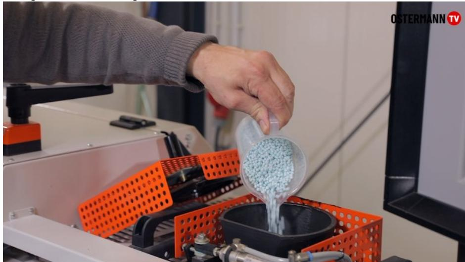
Vor der Rückstellung auf EVA wird Reinigungsgranulat eingefüllt, um das Ausreagieren von PUR-Rückständen in der Maschine zu verhindern. Bild: Ostermann
