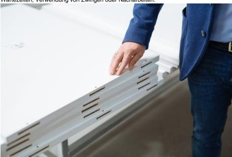
Bei Speedmaster wird die »P-System«-Fräsung in der Fläche mit einer Nesting-Maschine und stirnseitig mit einem Bearbeitungszentrum mit vertikaler Arbeitsfläche hergestellt. Bild: Lamello
