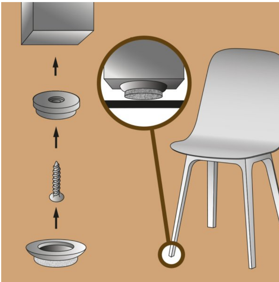
Gleiter aus natürlichem Lederfaser-Gemisch: »QuickClick Syno«. Bild: Wagner System
