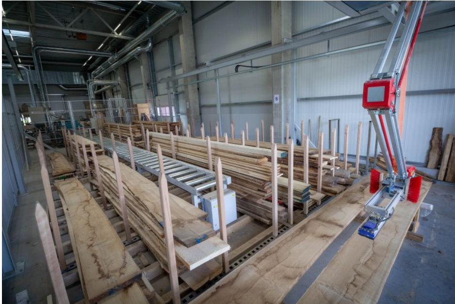
Die Bohlen werden in einem automatischen Rungenlager gelagert. Bild: Barbaric
