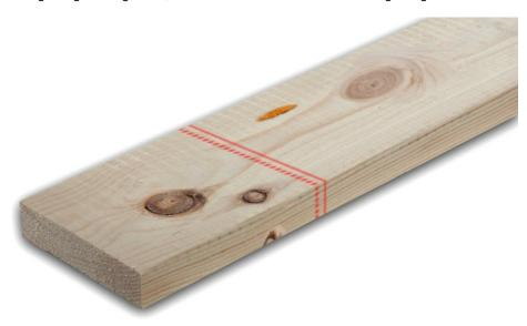
Das »Wood Scanning System« ermittelt mittels Linien- und Punktlaser Holzmerkmale, Geometrie und Dimensionen der Werkstücke. Bild: Paul
