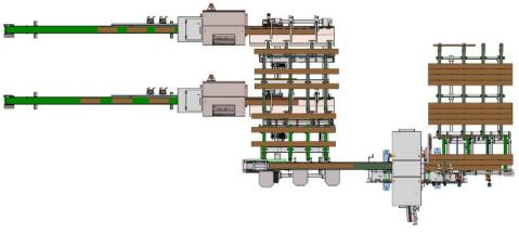
Das Kappsystem »C11\_Scan\_Duo« beim südamerikanischen Möbelhersteller ist mit Pufferstationen, Scansystem, zwei Kappstationen der Modellreihe »C11« und zwei Sortierbändern ausgerüstet. Bild: Paul
