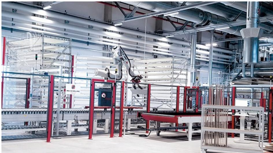
Ein Roboter lagert die Werkstücke in eine Sortierzelle ein und nach einer vorgegebenen Reihenfolge wieder aus. Bild: Reiss
