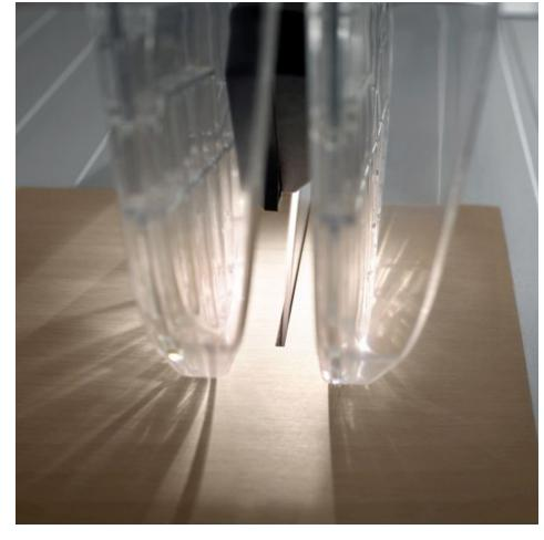
Für bestmögliche Sichtbedingungen am Sägeblatt wird der Schnittbereich mit einem LED-Licht ausgeleuchtet. Bild: Mafell
