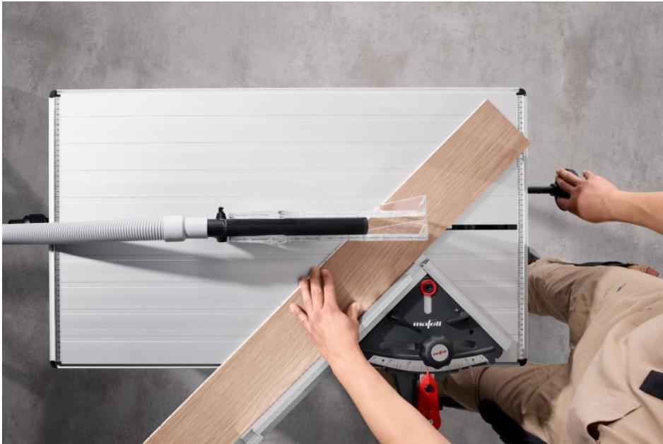
Mit dem Multifunktionsanschlag lassen sich Quer-, Längs- und Gehungsschnitte sowie falsche Gehrungen herstellen. Bild: Mafell
