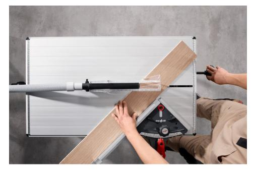
Mit dem Multifunktionsanschlag lassen sich Quer-, Längs- und Gehrungsschnitte sowie falsche Gehrungen herstellen. Bild: Mafell
