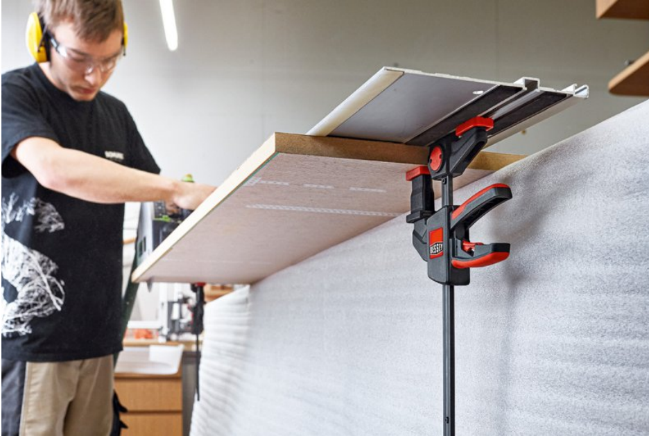
Anwendungsbeispiel Führungsschienen-Fixierung. Bild: Bessey
