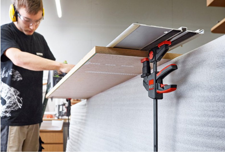
Anwendungsbeispiel Führungsschienen-Fixierung. Bild: Bessey
