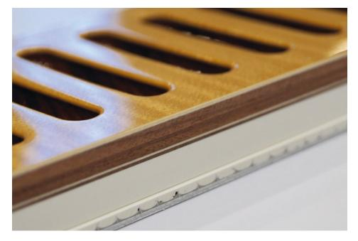
Verschiedene Hölzer sowie Furnier kombiniert mit Nonwood-Material und vor dem Lackieren mit dekorativen Lüftungsschlitzen gefräst, nach dem Lackieren nochmals an der Tischkreissäge formatiert. Bild: Leuco
