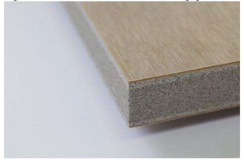
Sauber gesägter Mix aus feuerhemmender Mittellage mit hochwertiger Deckschicht: In diesem Fall wurde abrasives Blähglas mit einem spröden Furnier kombiniert. Bild: Leuco
