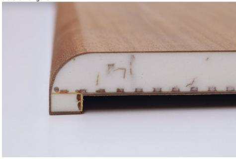
Furnierte Deckschicht und 2K-Kantenfüllung sauber und aussrissfrei gefräst mit dem Leuco- »p-System« in einer Tribos-Spannung. Bild: Leuco
