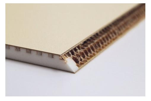
HPL-Deckschichten, Mittellage mit Wabenkern, Zwei-Komponenten-Kantenfüllung nach dem Aushärten auf Gehrung. Bild: Leuco
