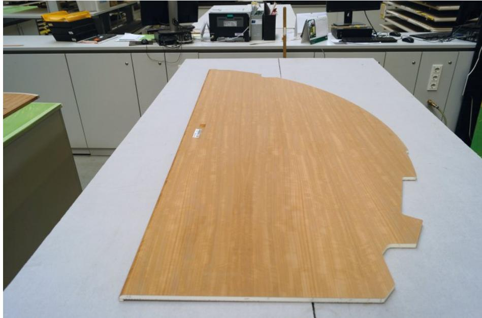
Saubere ausrissfreie Kanten im Furnier quer und längs zur Faser, gefräst mit Leuco-Werkzeugen im Nesting-Verfahren. Bild: Leuco
