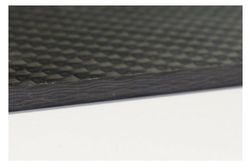
Bei Kohlefaserwerkstoffen werden glatte Kanten mit dem »p-System« mit 70° Achswinkel erzielt. Bild: Leuco
