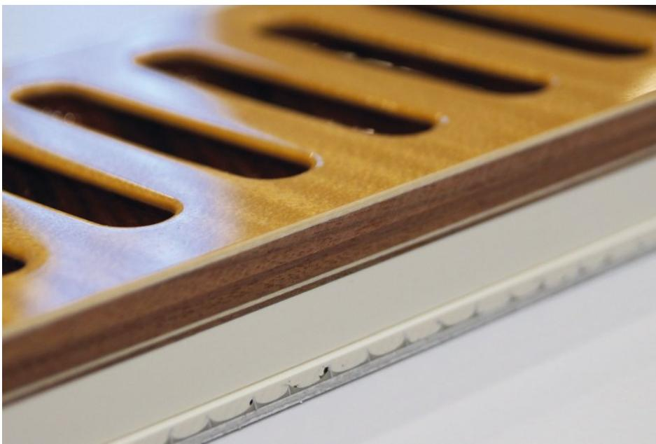
Verschiedene Hölzer sowie Furnier kombiniert mit Nonwood-Material und vor dem Lackieren mit dekorativen Lüftungsschlitzten gefräst, nach dem Lackieren nochmals an der Tischkreissäge formatiert. Bild: Leuco
