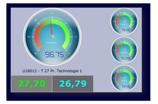
Schwingt die »Tacho«-Nadel in den roten Bereich, läuft die Maschine zu langsam, ist sie im grünen Bereich, läuft die Produktion wie geplant oder sogar schneller. Bild: Schlipf
