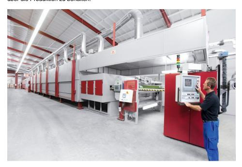
An der Imprägnierungsanlage bei Pfleiderer optimiert die Software »imASC« seit vielen Jahren den Produktionsprozess. Bild: Pfleiderer Deutschland GmbH
