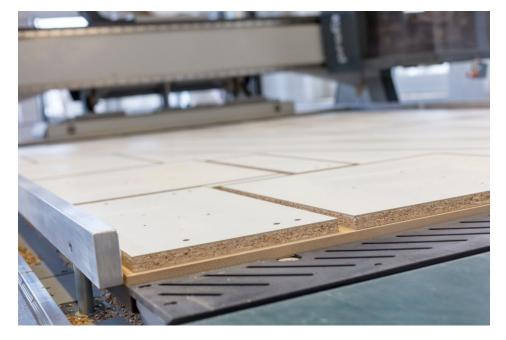
Eine besondere Herausforderung für die Absaugung sind die leistungsstarken CNC-Maschinen. Bild: Howind Furniture
