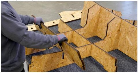
Die Spantenkonstruktion von Ackermann lässt sich mit unterschiedlichen Materialien beplanken.
