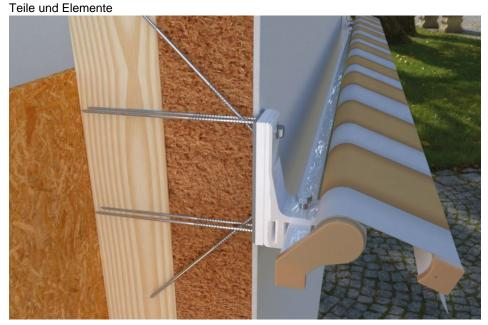
Für die Markisenbefestigung durch Wärmedämmverbundsysteme wurde ein neues Befestigungssystem entwickelt (Fischerwerke).
