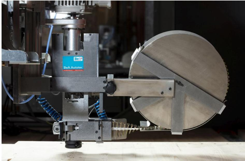
Der neue »Bea Autotec«-Schrauber (Behrens) ermöglicht eine schnelle, präzise und vor allem prozesssichere Einschraubung.
