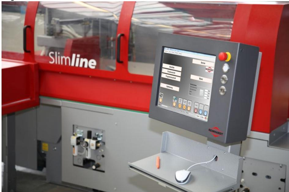
Schieberkappsäge »SlimLine Formatic« mit zusätzlichem Sägeaggregat zum Auftrennen von geschlossenen Decks (Reinhardt).
