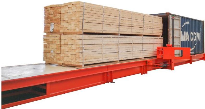
Mit dem Combi-CSS lassen sich Container schnell und effizient beladen – Transport über einen hydraulischen Zugmechanismus.
