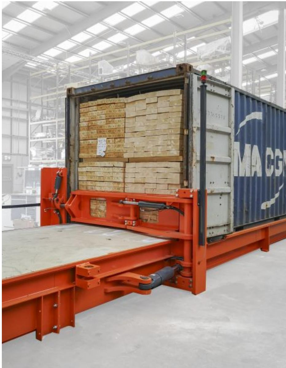
Sicherung des Transportgutes durch eine hydraulische Schranke.
