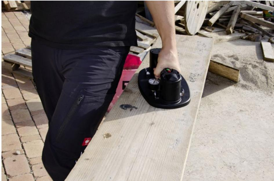
Der akkubetriebene Vakuumhandsauger Typ Nemo hebt unterschiedliche Materialien (Eurotech).
