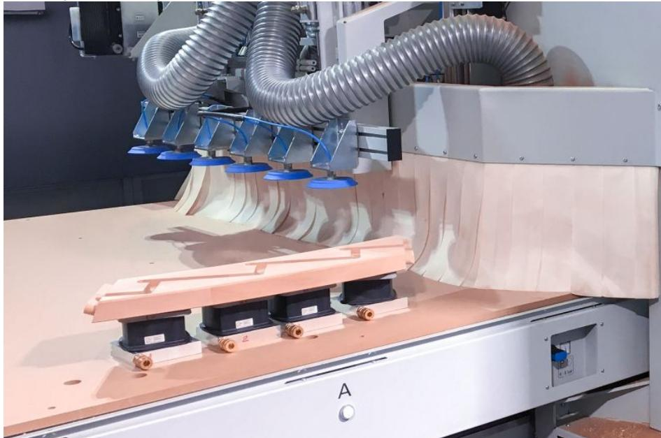
Mithilfe der Adapter-Plates »AP-G« können die Blocksauger »VCBL-B« auch auf Nestingmaschinen verwendet werden.
