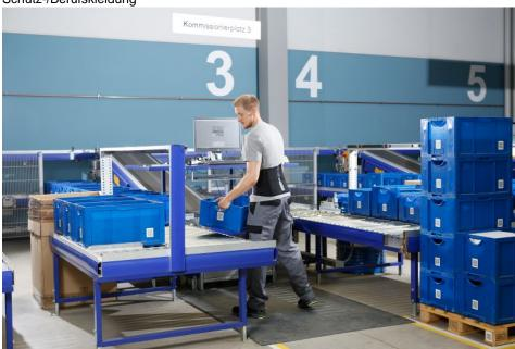
Ottobock erweitert die Produktpalette der industriellen Exoskelette u. a. mit »Paexo Soft Back« zur Unterstützung der unteren Wirbelsäule.
