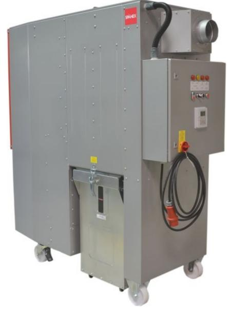
Dieser Mitteldruckentstauber von Spänex kommt auch bei der Absaugung von Handarbeitsmaschinen und Handarbeitsplätzen zum Einsatz.
