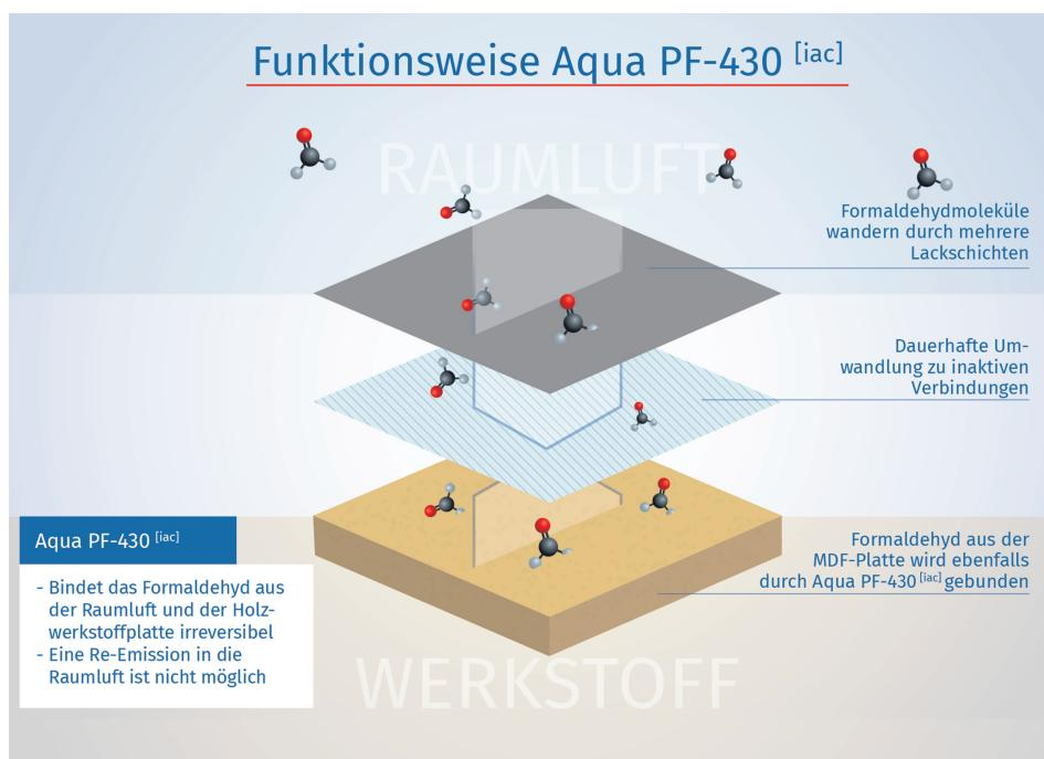
Funktionsweise: Der Pigmentfüller bindet Formaldehyd aus der Raumluft und der Holzwerkstoffplatte (Bild: Remmers).
