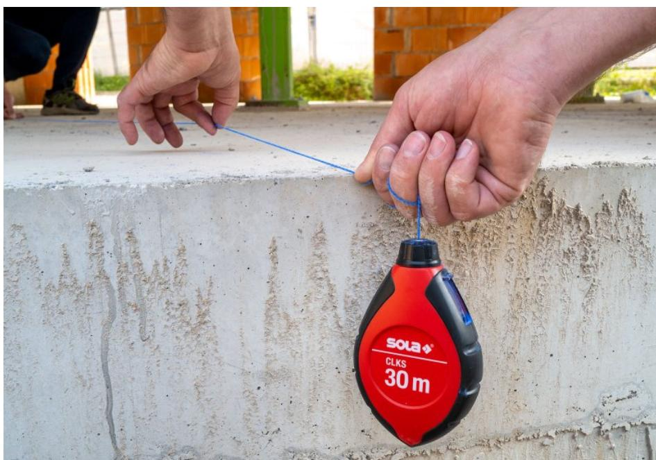
Das leichte und robuste Kunststoffgehäuse des neuen Schlagschnurgeräts ist ergonomisch geformt und bietet zuverlässige Stabilität (Bild: Sola-Messwerkzeuge).
