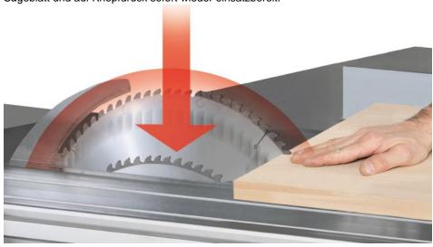
Die neue Sicherheitseinrichtung »Preventive Contact System« erkennt menschliches Gewebe in der Gefahrenzone und lässt das Sägeblatt in wenigen Millisekunden verschwinden (Bild: Felder Group).
