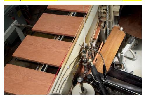
Das flexible System für den Kantenbeleimungsauftrag unterstützt verschiedene Klebstoffe, ein breites Spektrum an Beschichtungsbreiten sowie eine Vielzahl von Plattenformaten (Bild: Nordson).
