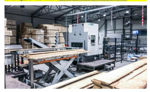
Der neu entwickelte Scanner für das optimierte Auftrennen von Massivholz (Bild: Paul Maschinenfabrik).
