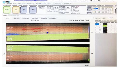
Optimierungsergebnis, bei dem das Werkstück zur Steigerung der Ausbeute in zwei verschiedene Richtungen aufgetrennt wird. Dies wird durch einen zweiten Durchgang ermöglicht (Bild: Paul Maschinenfabrik).
