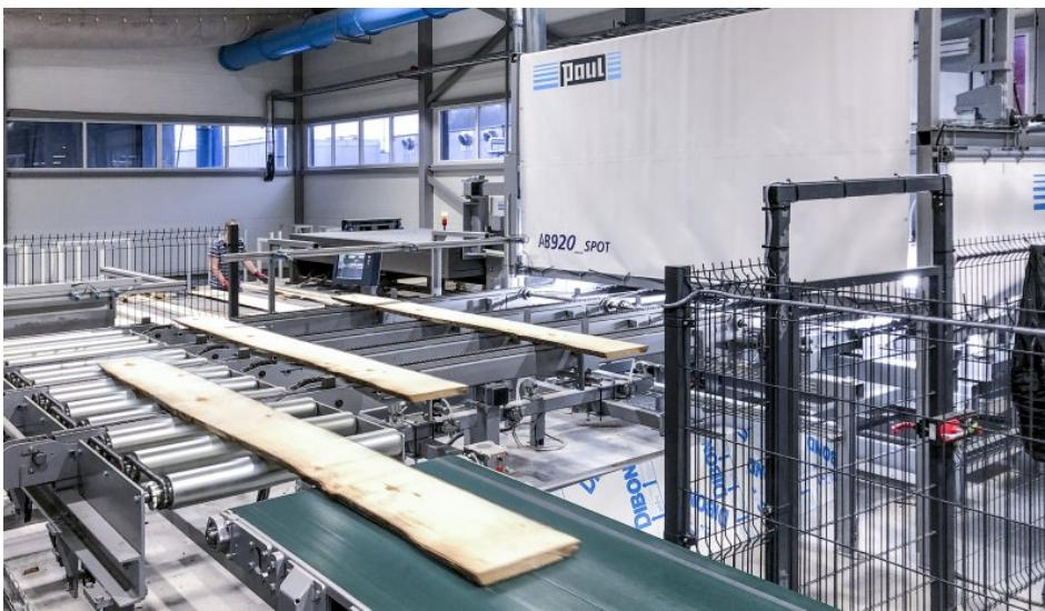
Die gescannten Werkstücke werden vom automatischen Beschickungssystem bestmöglich ausgerichtet und der flexiblen Auftrennkreissäge zugeführt (Bild: Paul Maschinenfabrik).
