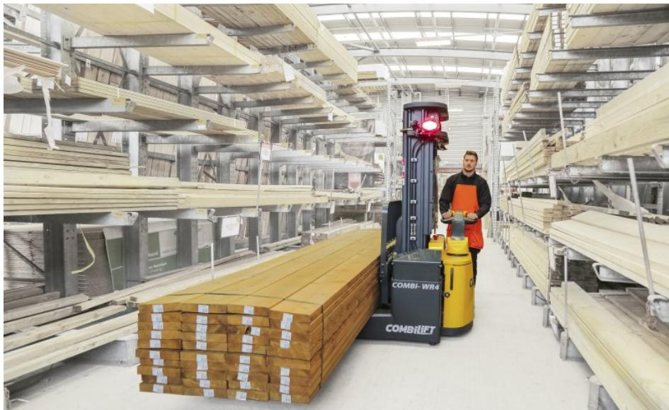
Deichselstapler ermöglichen das produktive Kommissionieren und Platzieren von Produkten in schmalen Arbeitsgängen (Bild: Combilift).
