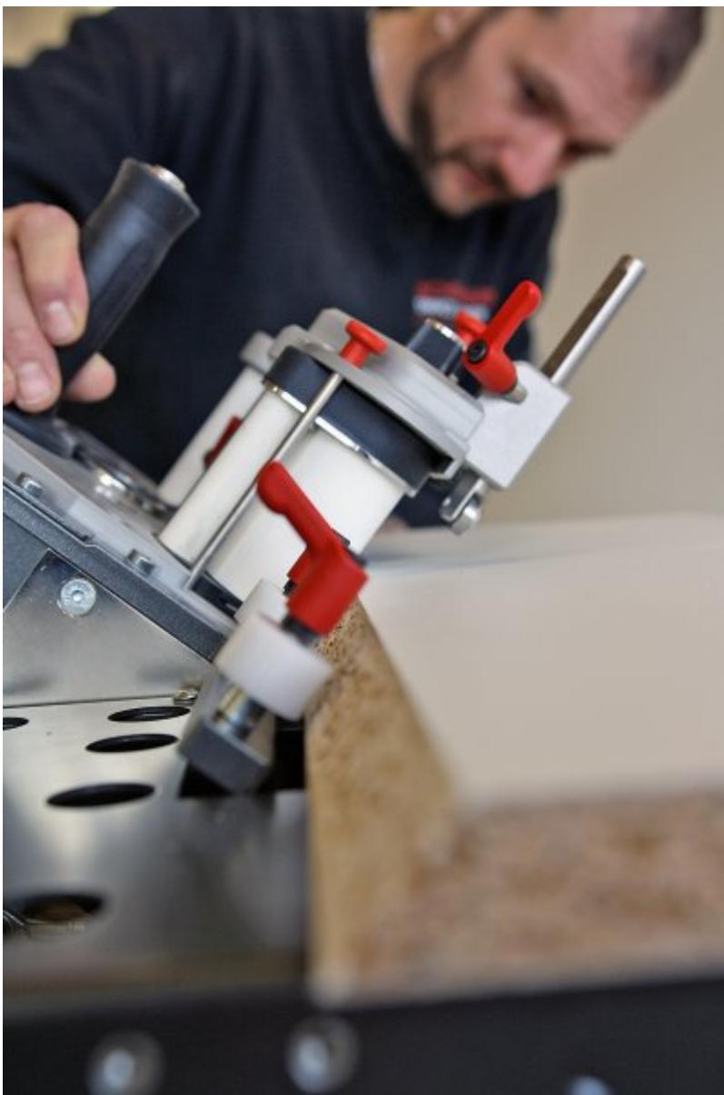
Mit dem mobilen Nullfugenbekannter werden auch schräge Kanten bis 55 Grad bearbeitet
