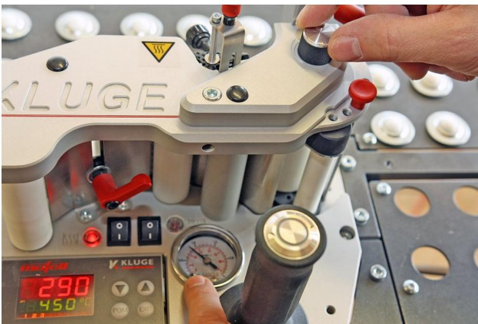
Der Nullfugenbekanter ist nach nur wenigen Sekunden Aufheizzeit betriebsbereit. Die übersichtliche Anordnung der Bedienelemente und die großen Anzeigen erleichtern das Arbeiten (Bild: Mafell).
