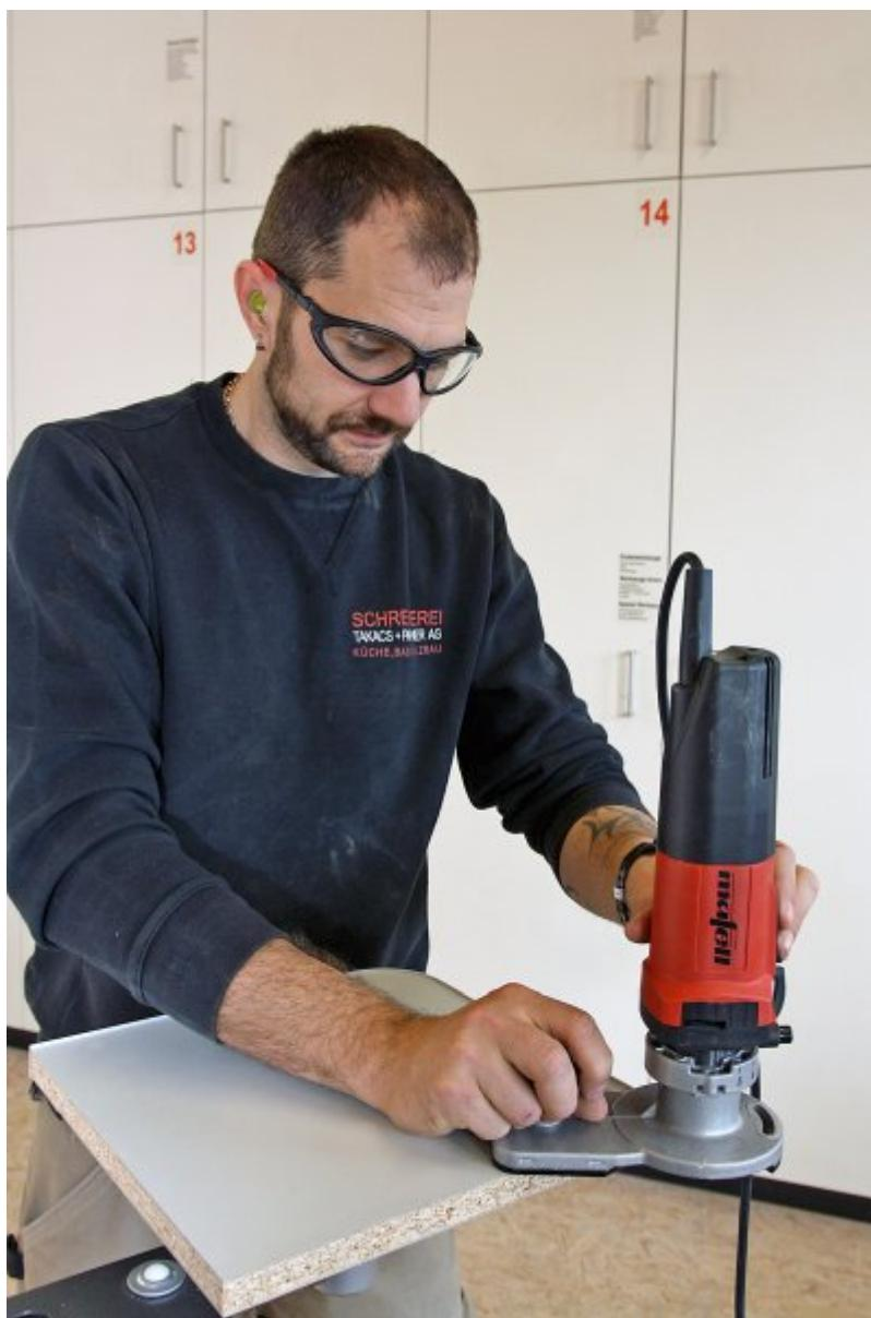
Zur Kantenbearbeitung mit der neuen Kantenfräse »KF 1000« wird das Werkstück auf dem Vakuumteller des Bearbeitungstisches fixiert (Bild: Mafell).
