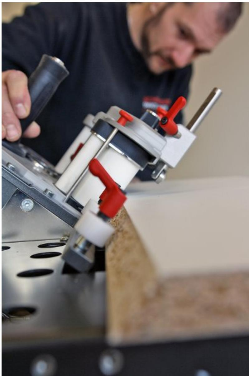
Mit dem mobilen Nullfugenbekannter werden auch schräge Kanten bis 55 Grad bearbeitet (Bild: Mafell).
