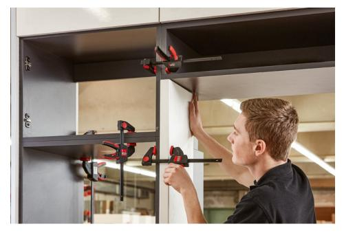
Die Zwinge ist unverzichtbar, wenn eine Hand zum Ausrichten des Werkstücks benötigt wird (Bild: Bessey).
