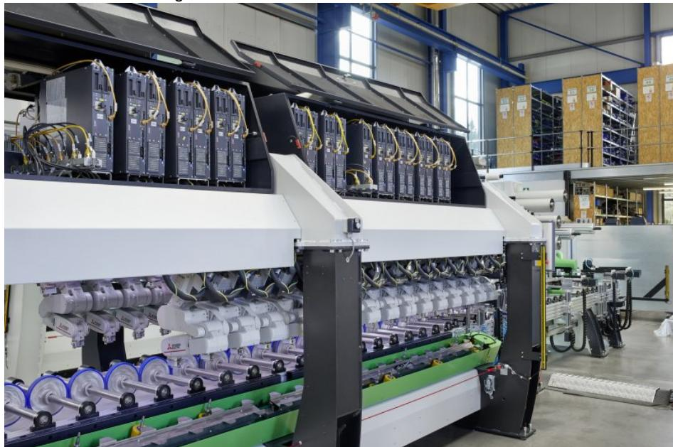
Diese Profilummantelungsmaschine mit 47 6-Achs-Robotern liefert reproduzierbare Ergebnisse (Bild: düspohl Maschinenbau).
