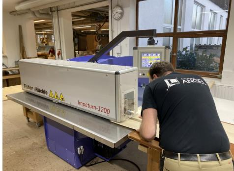
Die Furnier-Längszusammensetzmaschine bietet drei Einzugsarten für eine effiziente Beschickung (Bild: Fisher+Rückle).
