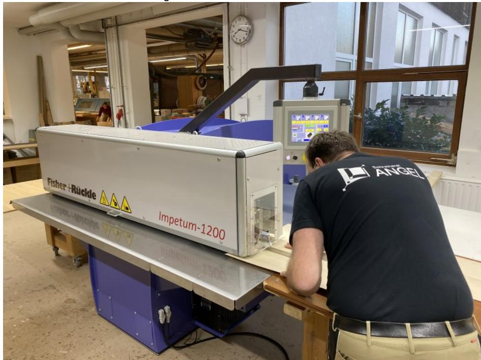
Die Furnier-Längszusammensetzmashine bietet drei Einzugsarten für eine effiziente Beschickung (Bild: Fisher+Rückle).
