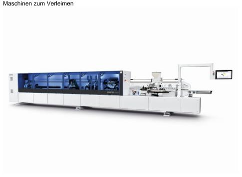
Die Kantenanleimmaschinen wurden für den Einsatz in Schreinereien und Tischlereien konzipiert (Bild: Homag Group).
