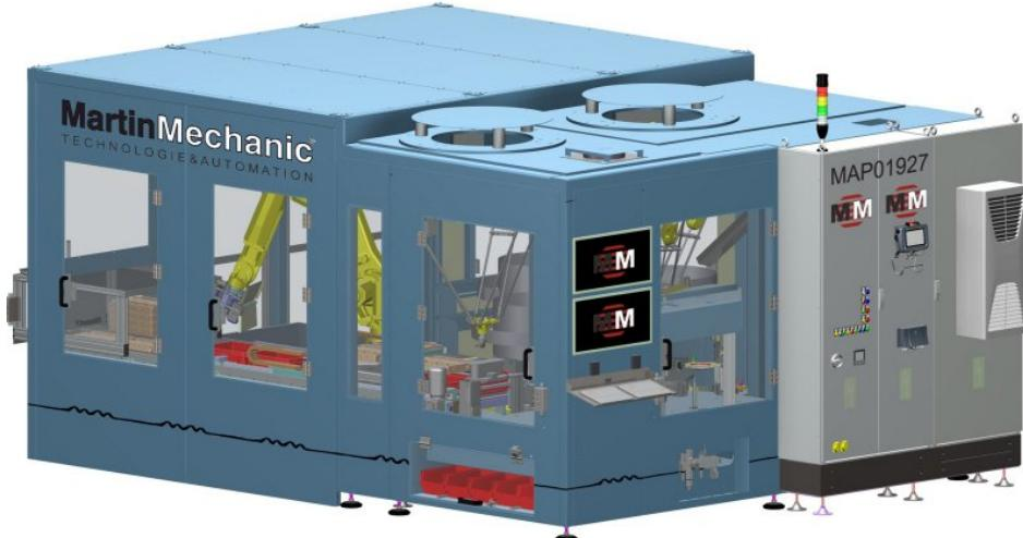
Die Prüfanlage für Möbelbeschläge verwendet unter anderem drei Roboter und acht Kameras (Bild: MartinMechanic).
