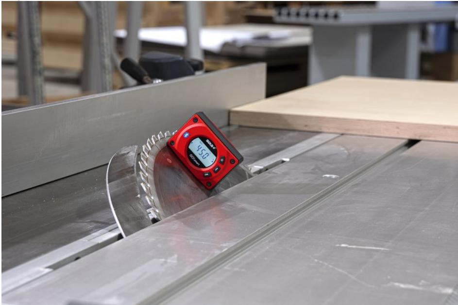
Der Neigungs- und Winkelmesser kann auch für die Winkeleinstellung von Sägeblättern verwendet werden (Bild: Sola-Messwerkzeuge).
